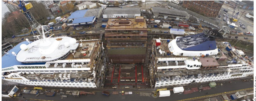
Schiffbautechnik, die begeistert: die BALMORAL bei ihrer Verlängerung 2008
